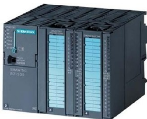
Рисунок 2.14 – Контроллер Siemens S7-300
